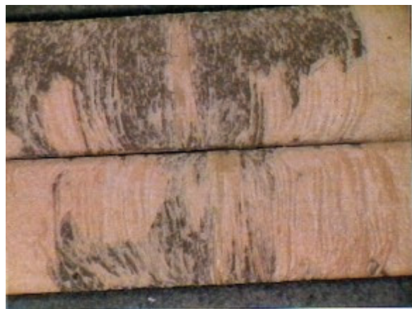
Abbildung 1 – Vergleich der Oxide der behandelten Teststreifen. Zustand I oben, Zustand IV in der Mitte, Zustand III unten.
