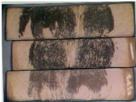
Abbildung 3 – Ergebnis der Haftverbund-Versuche: Zustand I oben, Zustand II in der Mitte, Zustand V unten.
